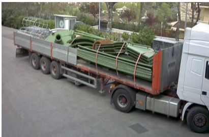
TRASPORTO VIA TERRA N.1 Silo 6CS5 senza accessori su un autocarro 13.60
