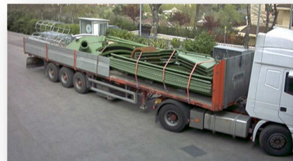
TRASPORTO VIA TERRA N.1 Silo 8CS5 con accessori su due autocarri 13.60
