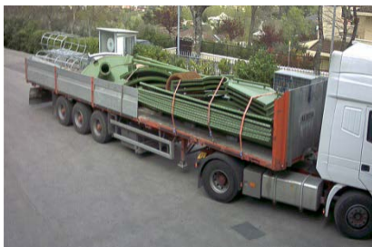
TRASPORTO VIA TERRA N.3 Sili CS90 senza accessori su un autocarro 13.60
