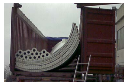
TRASPORTO VIA MARE N.2 Sili CS90 senza accessori in un container 40' OT
